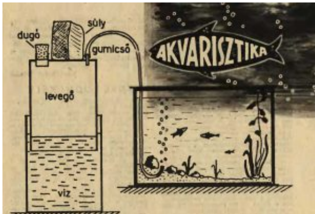
Akváriumszellőztető - konzervdobozokból vázlata
